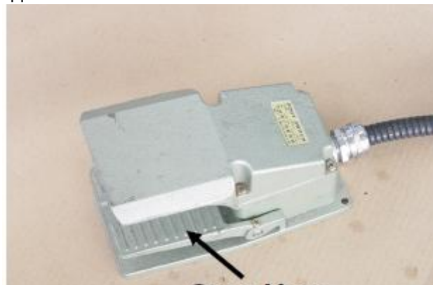
Рис. 6 – Ножная педаль для закрытия цанги
