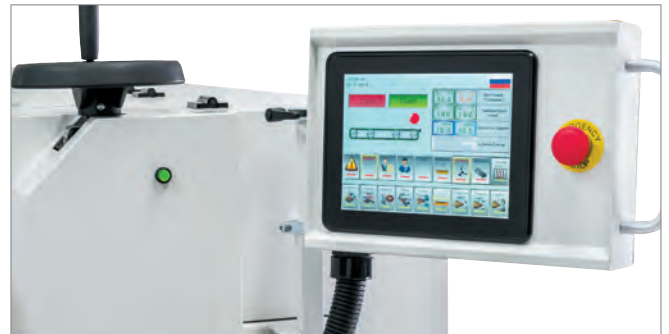
Управление всеми функциями станка производится с сенсорного экрана. Меню русифицировано и основано на сочетании текста и графики.
