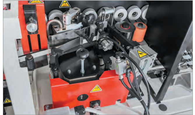
Узел нанесения клея включает в себя ролики для прикатки и гильотинный обрезчик рулона. Непосредственно перед нанесением состава склеиваемые поверхности подгреваются, что способствует лучшей адгезии.
