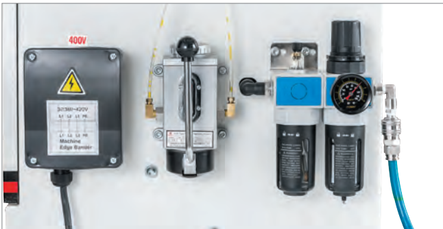
Станок оборудован централизованной системой смазки, что значительно облегчает ежедневное обслуживание и продлевает срок эксплуатации трущихся пар.
